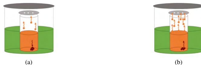
Rysunek S-10: Rysunek poglądowy różnic w zachowaniu krystalizującego roztworu dla: (a) temperatury niższej; (b) temperatury wyższej; na pomarańczowo rozpuszczalnik, na zielono antyrozpuszczalnik, na brązowo substancja poddana krystalizacji.
