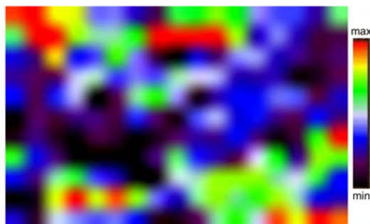
Rysunek 3.19: Obraz z mikroskopu ramanowskiego fragmentu powierzchni czystej folii PMMA dla pasma 3571\text{ cm}^{-1} .
