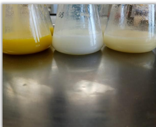
Rys.2.5. Otrzymane hydrolizaty olejów roślinnych (po 12h) i rozdzielanie mieszaniny kwasów tłuszczowych od produktów ubocznych
