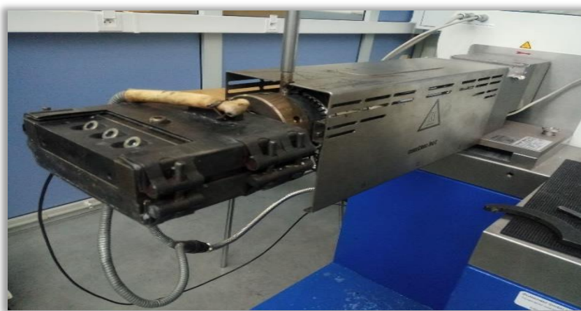
Rys.2.1. Zdjęcie wyłaczarki jednoślismakowej 19/25D (Brabender, Niemcy) wyposażonej w głowicę wąskoszczelinową (Ł – IMPIB; 2019)
