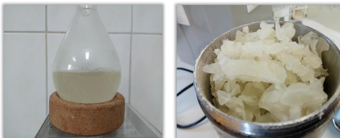
Rys.2.3. Skrobia skleikowana przy użyciu chlorku 1-butylo-3-metyloimidazoliowego (postać mokra i wstępnie wysuszona)
