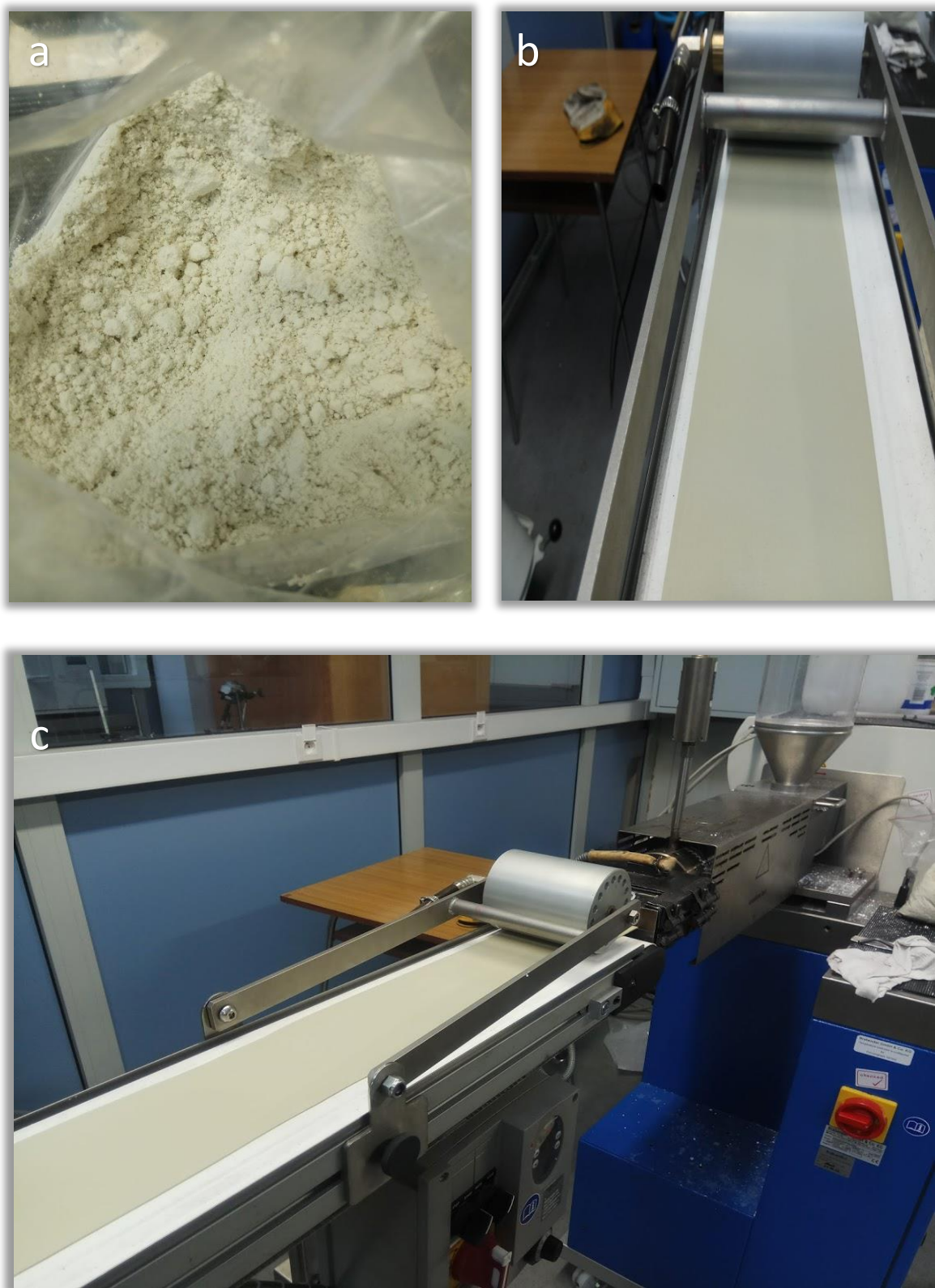
Rys.2.32. Ester skrobiowy HR/4/50/30/B w formie proszku (a) i w formie folii wytłoczonej na wytłaczarce jednoślindakowej (b, c), (Ł-IIMPiB, Toruń, 2018)
