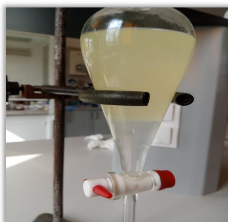
Rys.2.5. Otrzymane hydrolizaty olejów roślinnych (po 12h) i rozdzielanie mieszaniny kwasów tłuszczowych od produktów ubocznych
