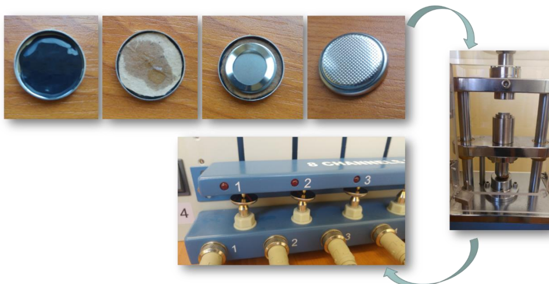
Rys. 47. Proces przygotowania baterii pastylkowej [356]
